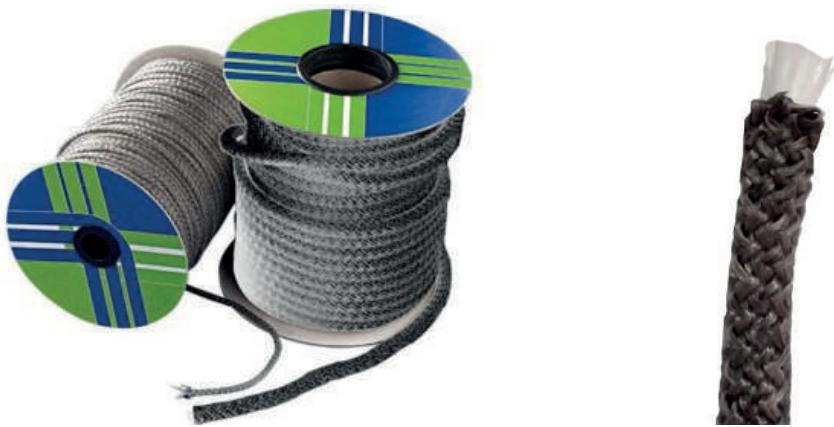
■ ■ La treccia Artica, è una guarizione realizzata mediante trecciatura di fili di vetro neri "HT", con anima interna per aumentare la densità. Resiste fino a 750°C. La particolare trecciatura realizzata con macchine ad aghi evita lo sfilacciamento al taglio e la rende particolarmente morbida e flessibile.
