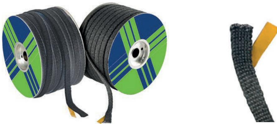
■ Il nastro Textape è fabbricato interamente con filati di vetro 6-9 um che resistono a temperature fino a 550°C. Caratteristica principale è la produzione mediante la tessitura ad aghi, che rende il nastro elastico, soffice e particolarmente adatto per isolare vetri di caminetti e stufe. Per facilitare l'applicazione è fornito di un lato biadesivo (l'adesivo resiste fino a temperatura massima di 120°).
