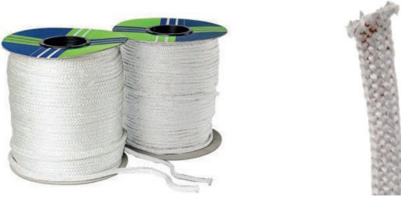
La treccia Tricotex è una guarnizione realizzata mediante trecciatura di fili di vetro bianchi o neri "HT", che consentono alla treccia di resistere fino a 550°C per la treccia bianca e fino a 750°C per la treccia nera. La particolare trecciatura realizzata con macchine ad aghi, evita lo sfilacciamento al taglio.
